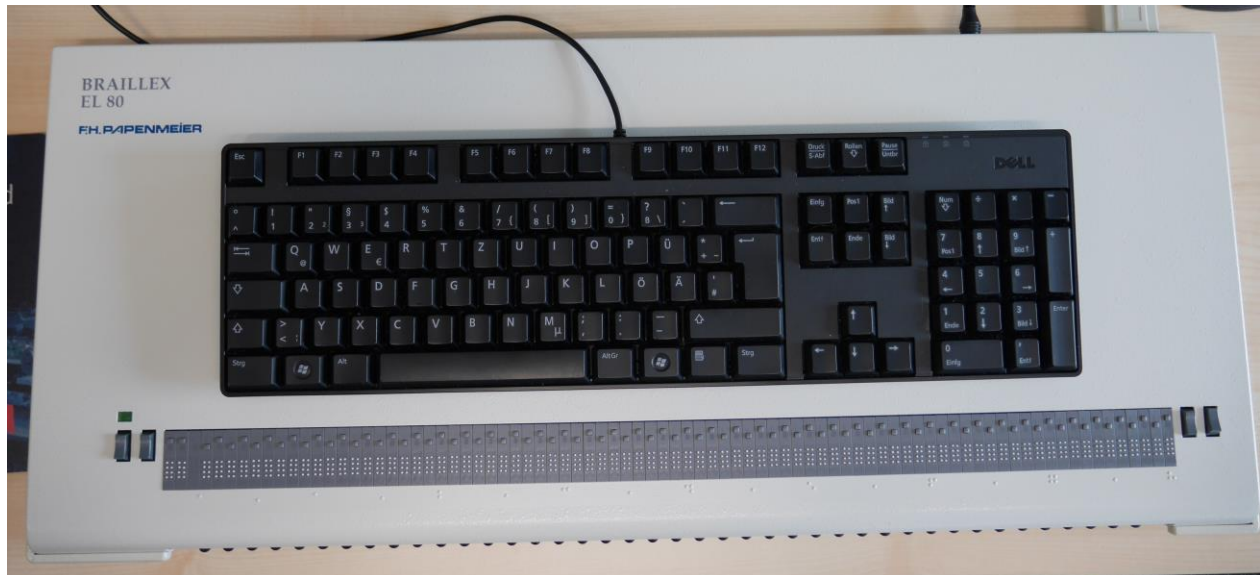
Braillezeile im Lernraum (K.12.27) zur Ausgabe von digitalen Texten in Blindenschrift
